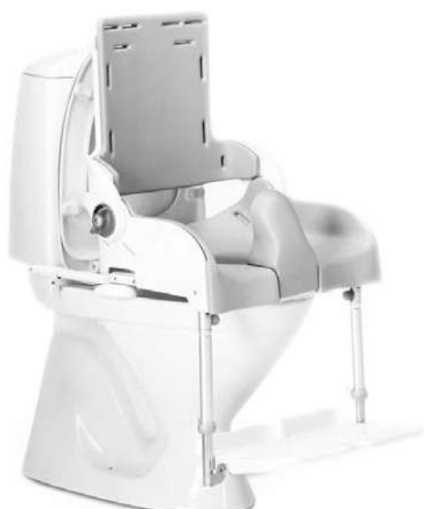
Art. 831401/2/3/4 - Supporti per fissaggio alla toilette regolabile in altezza, in senso antero-posteriore, in inclinazione. Il supporto è composto da tre tubolari, due fissati al sedile median- te brugole, ed uno fatto passare dietro alla toilette e fissato agli altri due. Il supporto è di tipo universale quindi adatto ad ogni tipo di toilette.
