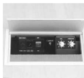
pannello controllo kit elettronico con regolazioni per il volume e per l'intensità della vibrazione
