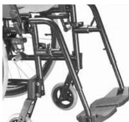
Pedane con rotazione antero-posteriore
